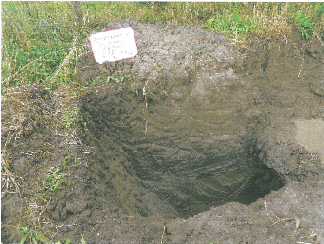
Pozzetto geognostico Pz.1
