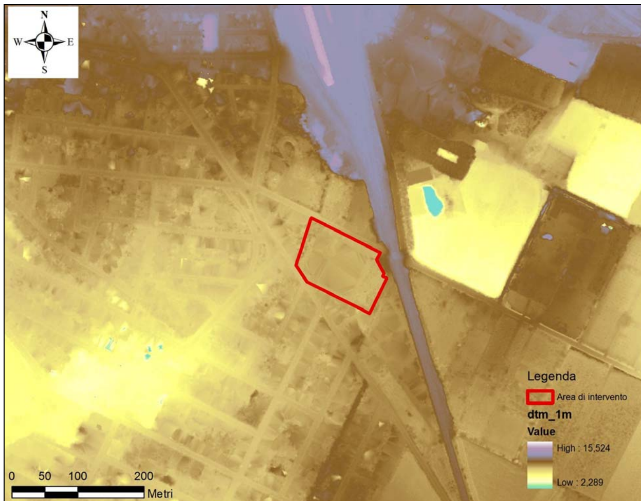
Figura 8. DTM ricavato dal volo LIDAR 2008 RAS: si osserva la modesta escursione altimetrica, con quote massime di circa 15,6 metri. L'area di intervento giace ad una quota media di circa 10,00 metri s.l.m.
