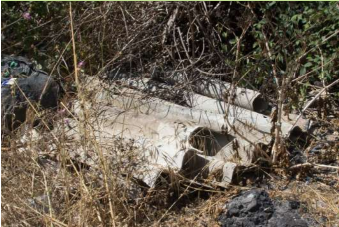
Pannelli di copertura in fibrocemento (tipo Eternit)
