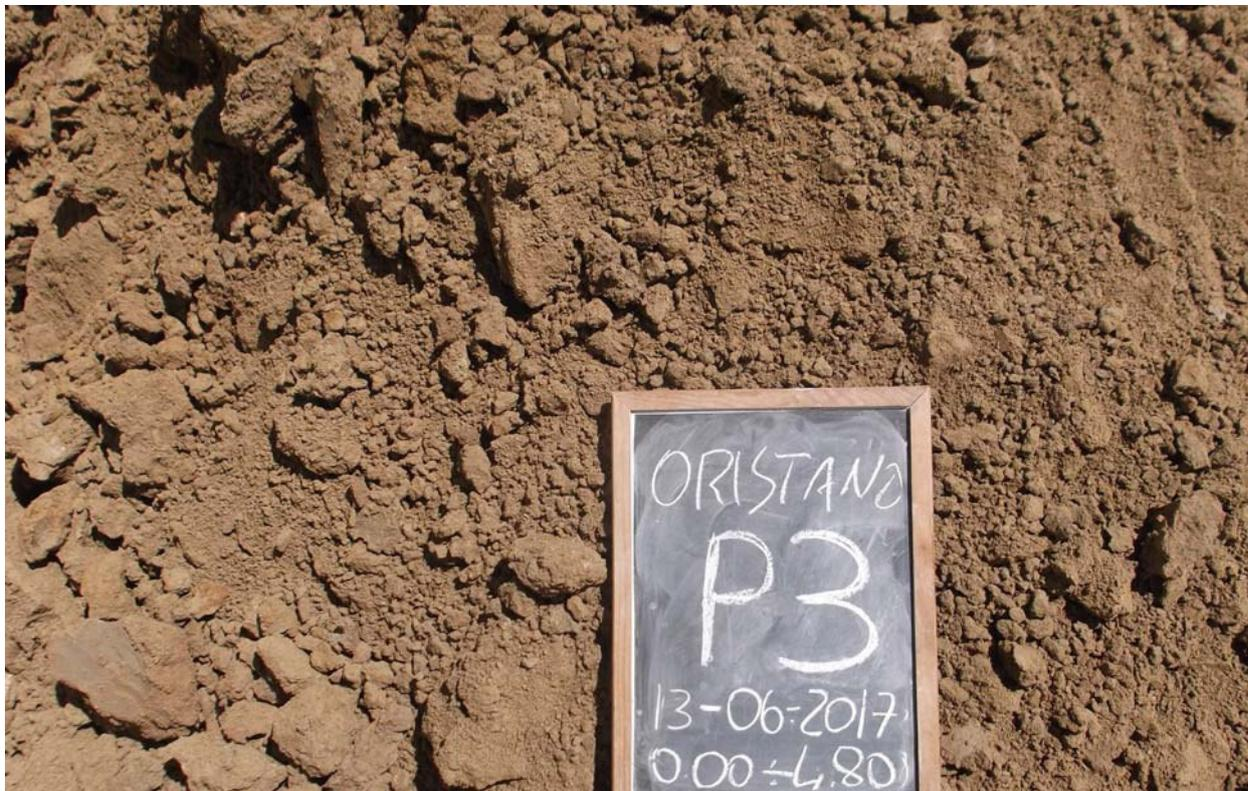
Figura 7. Pozzetto 3: sabbie limose campionate da 3,10 a 3,90 metri di profondità.
