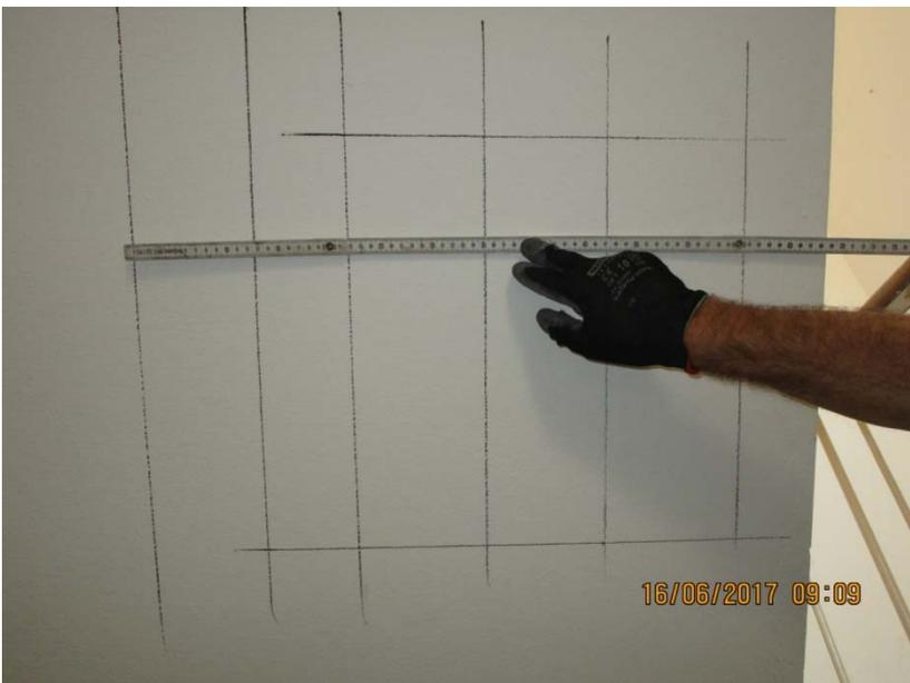
**Foto n.12:** Indagini sulla soletta in c.a.della scala - individuazione armature mediante pacometro
