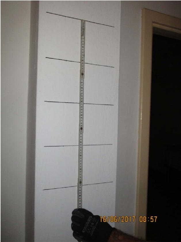
**Foto n.11:** Indagini su pilastri in c.a. - individuazione armature mediante pacometro
