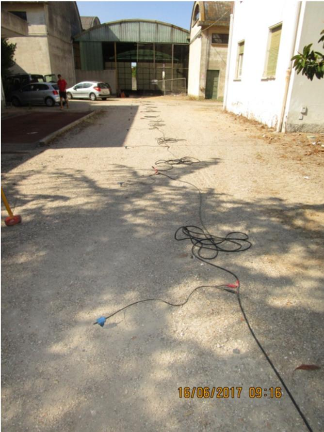
**Foto n.13:** Indagini indirette sui terreni - sismica a rifrazione
