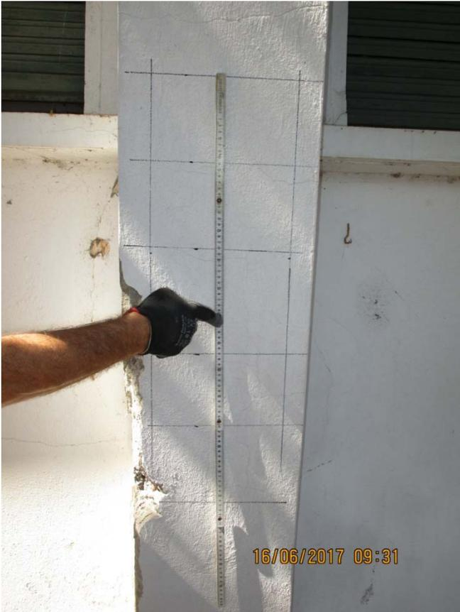
**Foto n.15:** Indagini sui pilastri in c.a. di facciata - individuazione armature mediante pacometro
