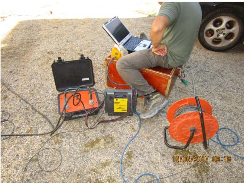
**Foto n.14:** Indagini indirette sui terreni - sismica a rifrazione
